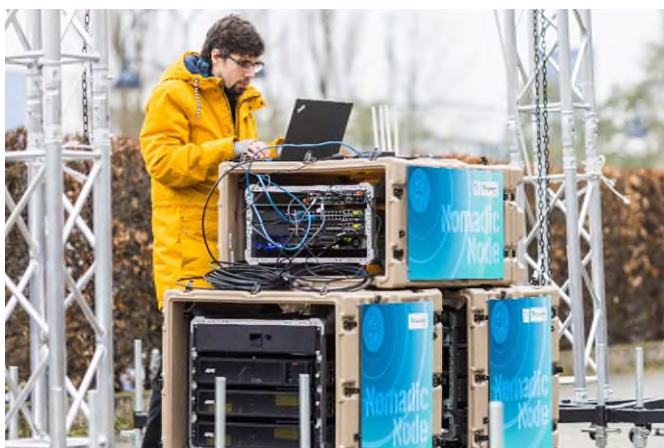
Abb. 1 Die komplette Hard- und Software des 5G+ Nomadic Node passt in wenige mobile Server-Koffer.
